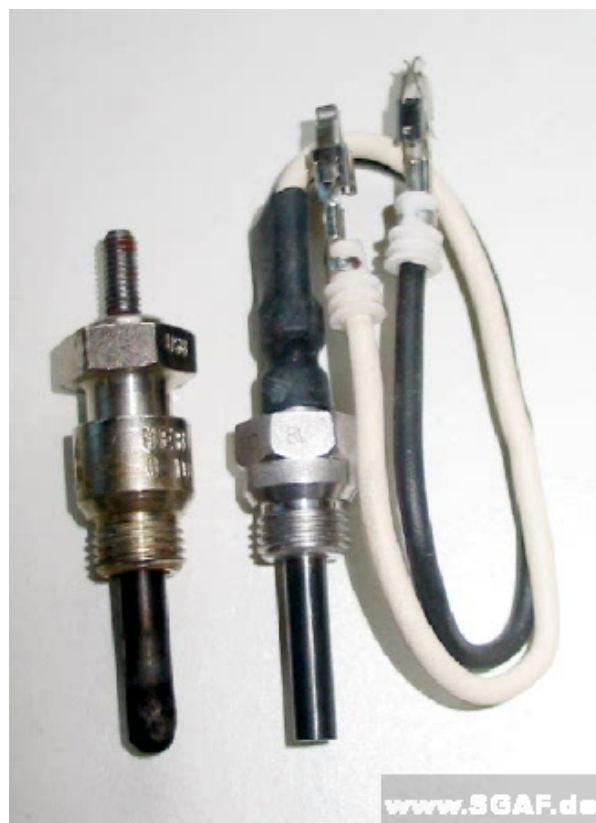
Obrázek 14: keramická žhavicí svíčka (vpravo) ve srovnání s kovovou žhavicí svíčkou
