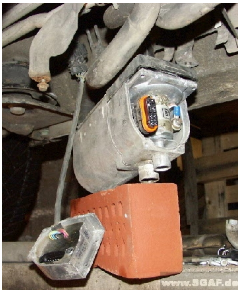
Obrázek 12: Odmontovaná řídicí jednotka
