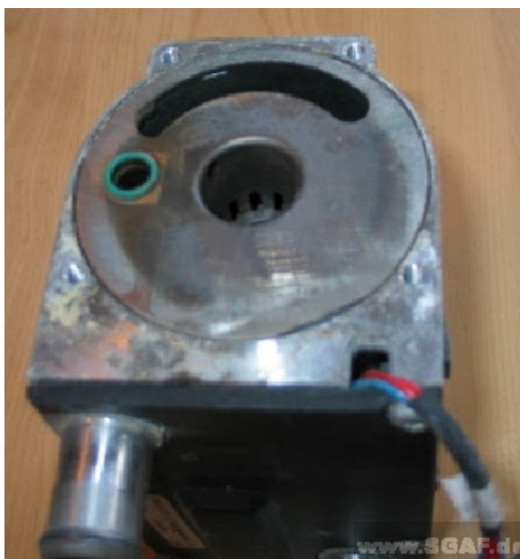
Obrázek 6: Sada hořáku s hubicí hořáku (střed) průchodka pro sítko (nalevo) výfuk (nahore)
