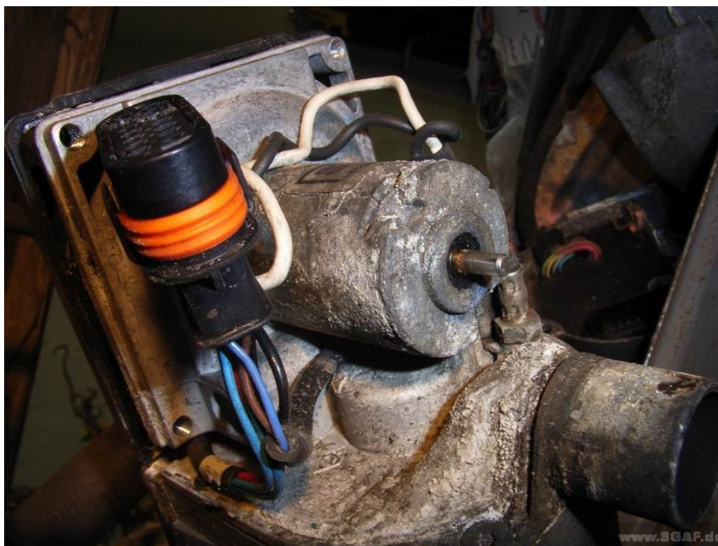
Obrázek 19: Plášť dmyhadla po vniknutí slané vody pod kryt Bufíku
